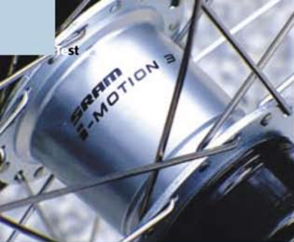
An einem Kinderrad und einem Cruiser entdeckt: die Sram „i-Motion 3“ mit Rücktrittbremse
